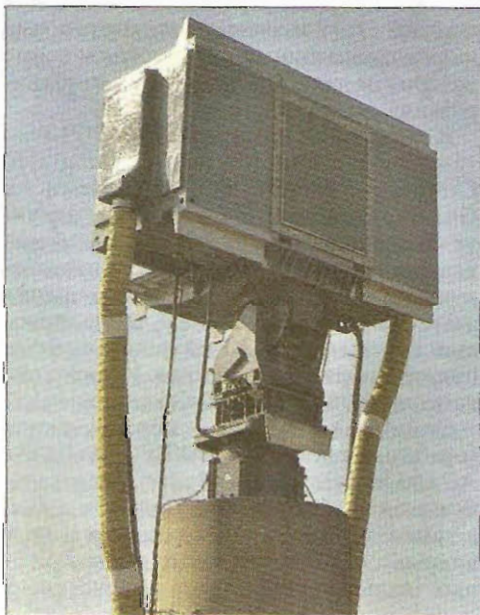
Внешний вид антенной системы прототипа РЛС «АМДР-S» корпорации «Нортроп-Грумман»
