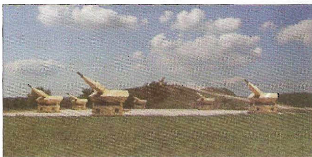
В состав системы MANTIS входят шесть артиллерийских установок, две ПЛС и пункт управления
