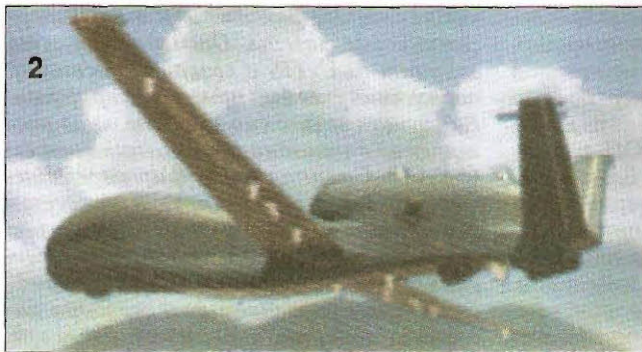
Воздушный узел связи и ретранслятор BACN на базе: 1 – самолета E-11A; 2 – стратегического БЛА EQ-4B
