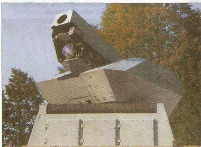
Лазерная установка, смонтированная на вращающейся турели комплекса MANTIS
